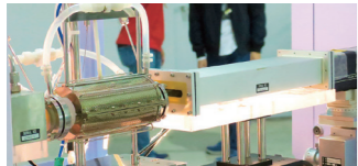
触媒反応中の金属ナノ粒子の状態をリアルタイムに観測するための反応セル
